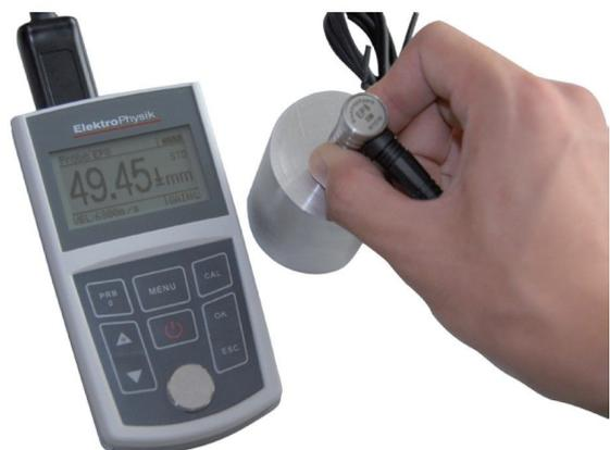
高精度超声波测厚仪
